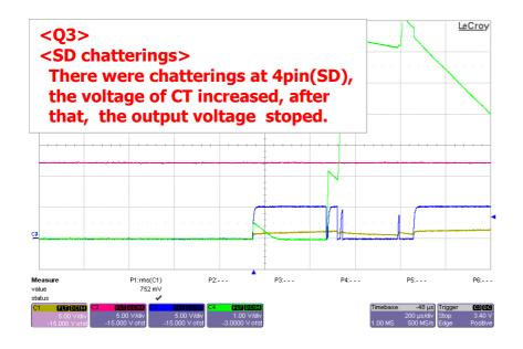
C1:Gate-SG C2:D-SG C3:SD-SG C4:CT-SG
