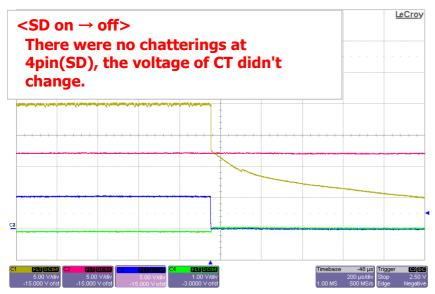
C1:Gate-SG C2:D-SG C3:SD-SG C4:CT-SG
