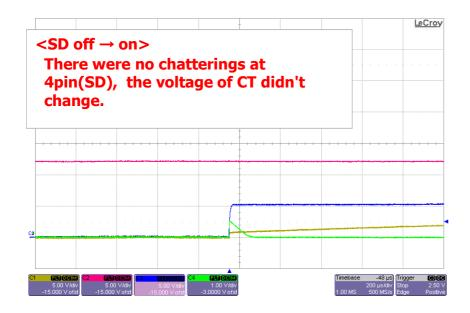
C1:Gate-SG C2:D-SG C3:SD-SG C4:CT-SG
