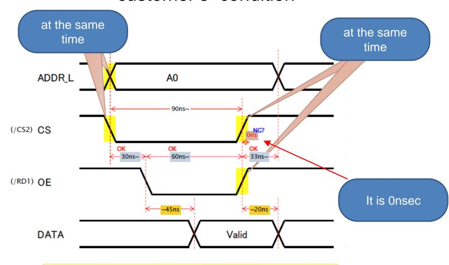
CPUが、/CS2と/RD1が同時にデアサートされる仕様なので、 Datasheetに記載の t<sub>h6</sub> (=10ns min.) が取れない
