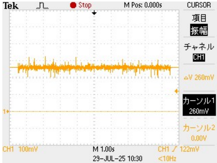
オシロスコープによる5V-ADC0間の波形
