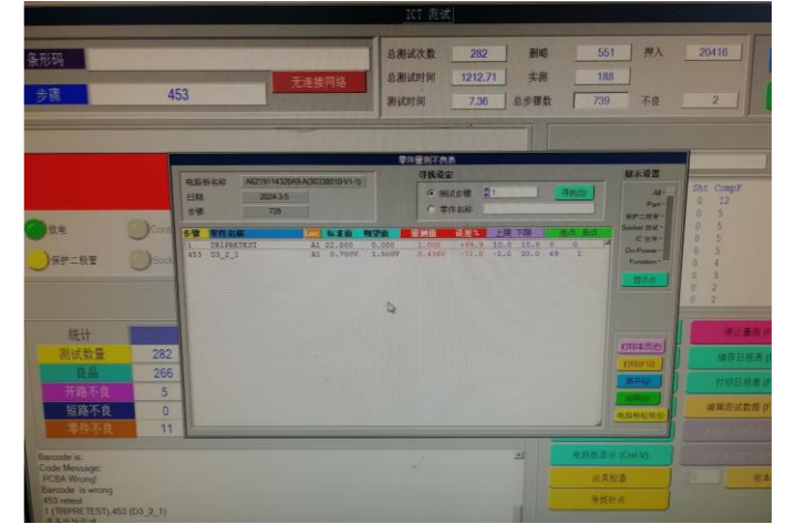
不良板复原U108 ICT测试NG
