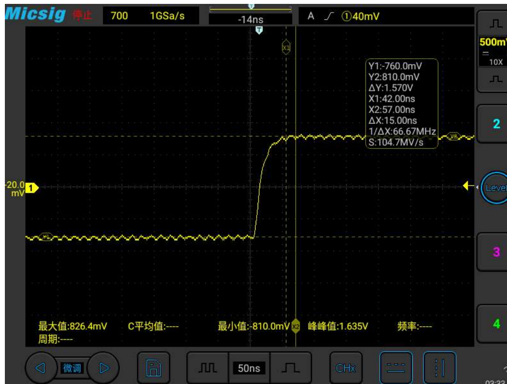
图2：平台2使用DP83TC812 PMA mode1波形
