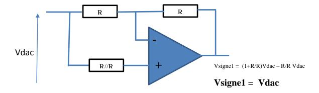
L'assemblage des 2 montages en utilisant un commutateur analogique donne le montage suivant :
