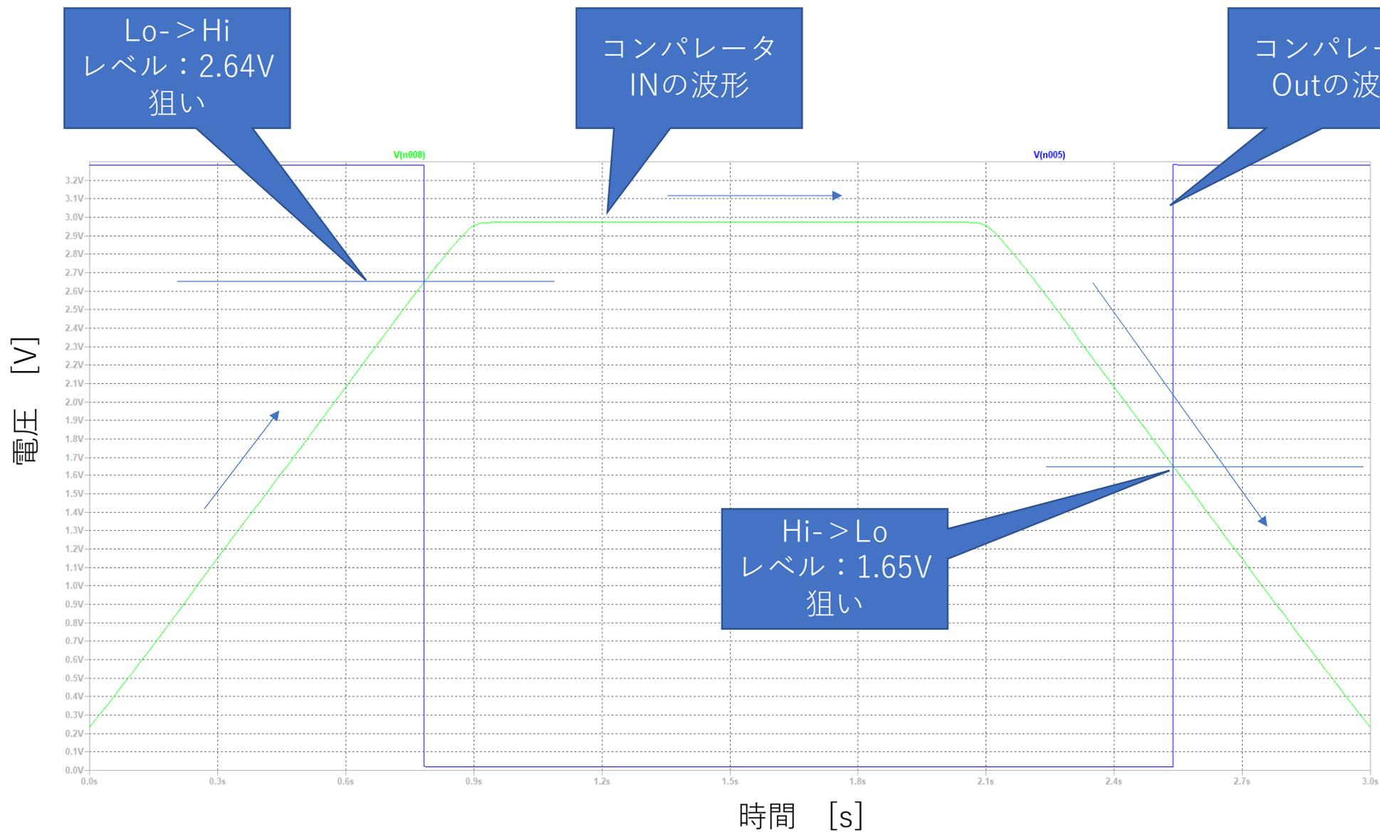
★コンパレータIN波形は遷移電圧をわかりやすくするため、緩やかに立ち上げ、下げてます
