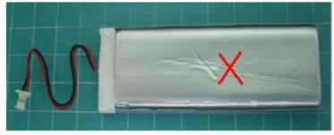
10.2 Sealed edge may be damaged by heat above 100°C, bend or fold sealed edge. 封边被加热到 100°C 以上以及弯折封边都容易使封边受损。
