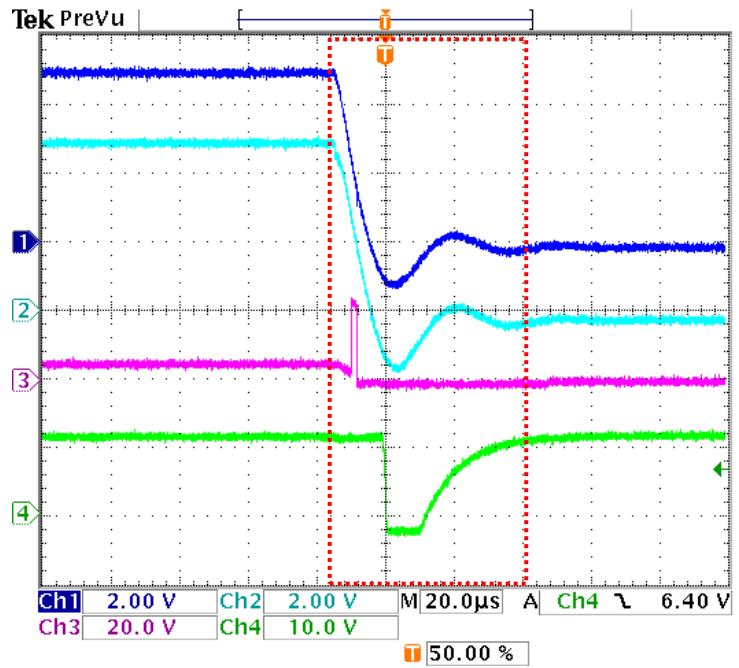
Vin=24V, Vout=5V, Iout=0A  $\Rightarrow$  Vout-GND short
