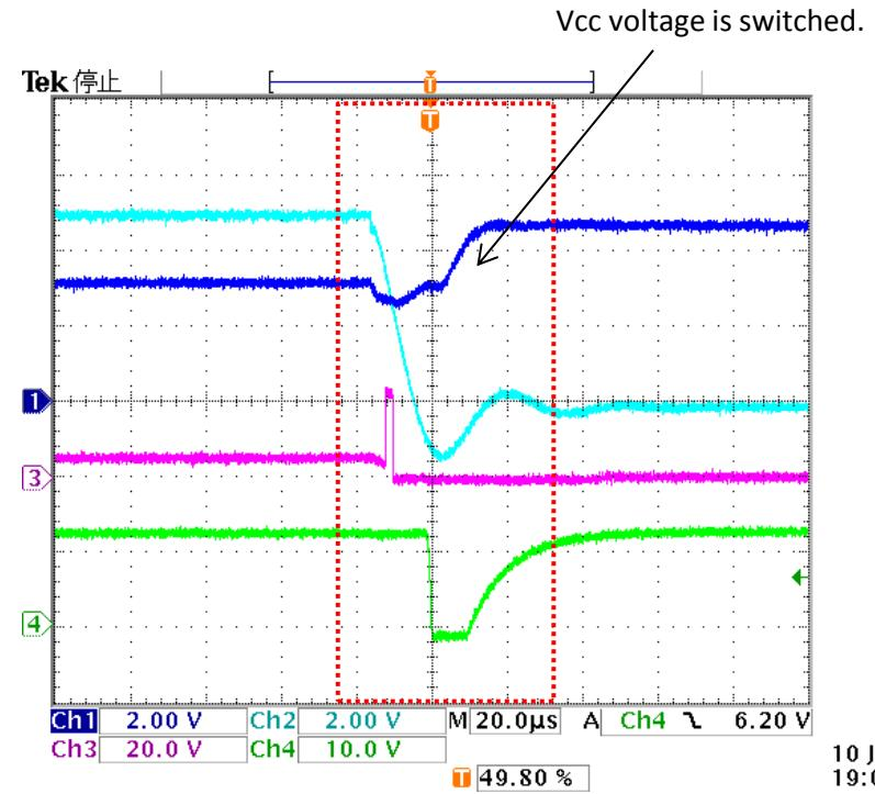
Vin=24V, Vout=5V, Iout=1.5A  $\Rightarrow$  Vout-GND short
