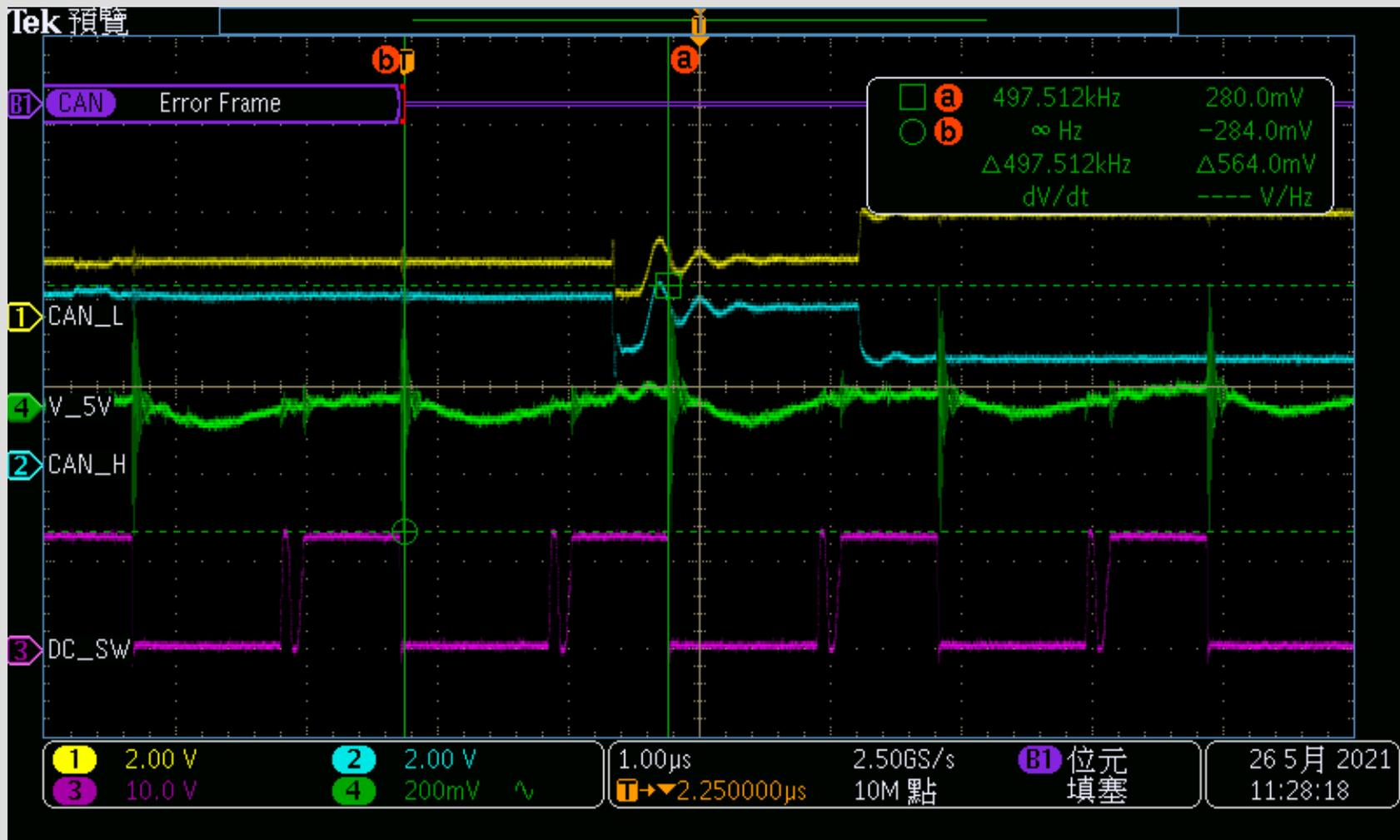
TPS562201 輸入 14V, 輸出 5V 在輸出電流 dashboard 加載 300mA 時振盪頻率約在 500KHz (TPS562201 會隨輸入輸出電壓電流改變振盪頻率)
