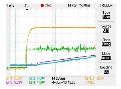
CH1 VBUS\_L CH2 VSYS\_L CH3 VBAT\_L CH4 ILIM\_HIZ\_L
