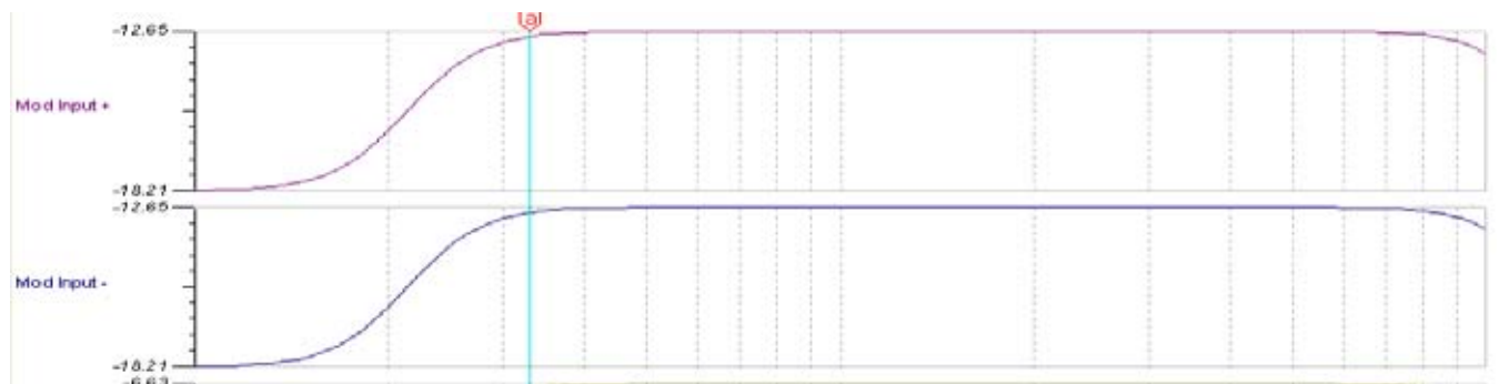
图 11 交直流耦合频响特性
