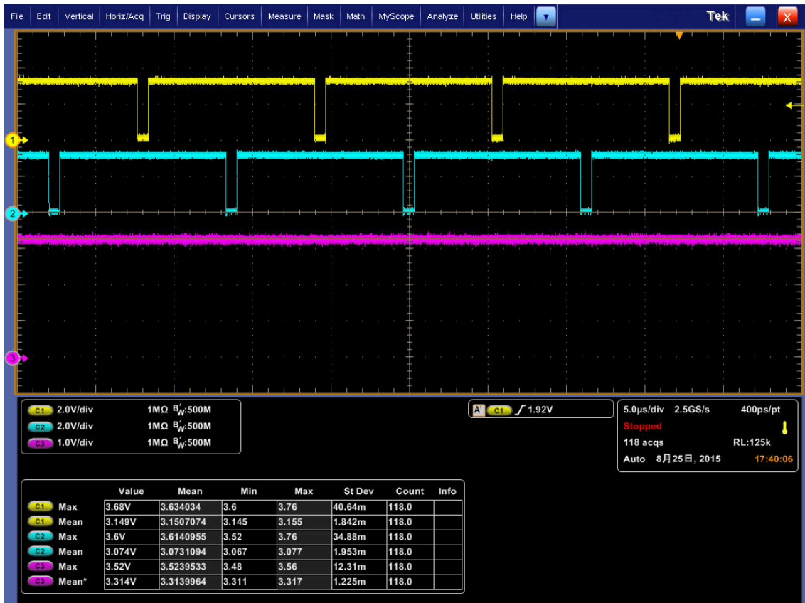
Fig. 5. OUT1 (CH1) , OUT2 (CH2) , REF 端子 (CH3) 電圧波形 (横軸 5μsec./div.)
