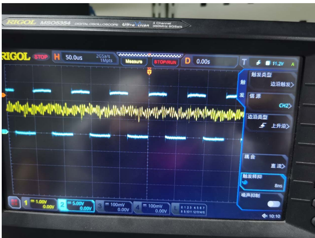
黄色 ISENA 蓝色 ISENB, 电流已经增加到 920Ma. Yellow represents ISENA, blue represents
