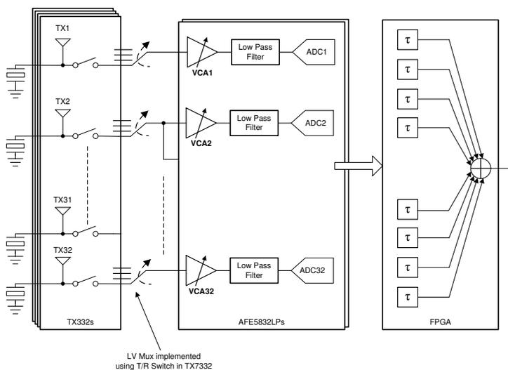
图 7. 具有 128 通道 TX 和 64 通道 AFE 的系统架构
