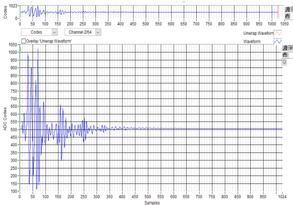
图 12. 收发器测量结果：由 FPGA 捕获的脉冲回波
