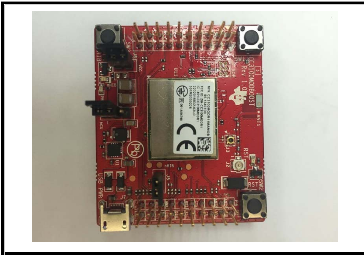
整体照 物理尺寸：长 X 宽 X 高=50 mm(L) X 34 mm(W) X 24mm(H)
